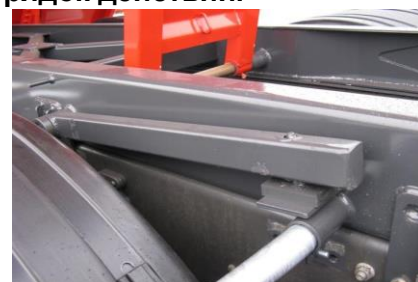
Рис. 3.1.2. Опора для кузова.
