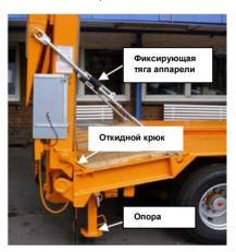
После разблокирования аппарель можно полностью опустить. В процессе опускания аппарель автоматически раскладывается с помощью специального штока. Клапаны управления аппарелями находятся в задней части полуприцепа, под наружной рамой.
