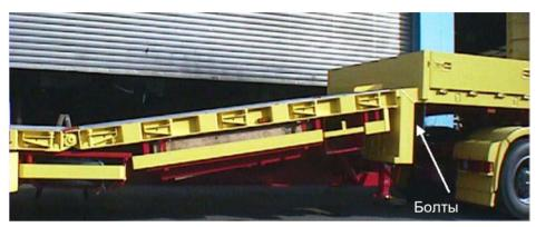
Управляющий клапан для подъема или опускания пандуса находится с правой стороны полуприцепа, на пульте управления. В дорожном положении пандус следует перевести в опущенное или поднятое положение и вручную закрепить болтами. Опускать и поднимать пандус можно только в разгруженном состоянии, при отсоединенных болтах. Если по пандусу предполагается движение техники массой более 3 т, пандус необходимо механически закрепить болтами.
